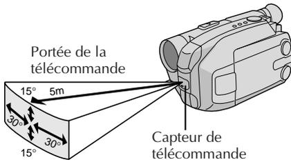
En utilisant la télécommande, bien la diriger vers le capteur de télécommande. L'illustration ci-dessus montre la portée de la télécommande pour l'utilisation en intérieur.
